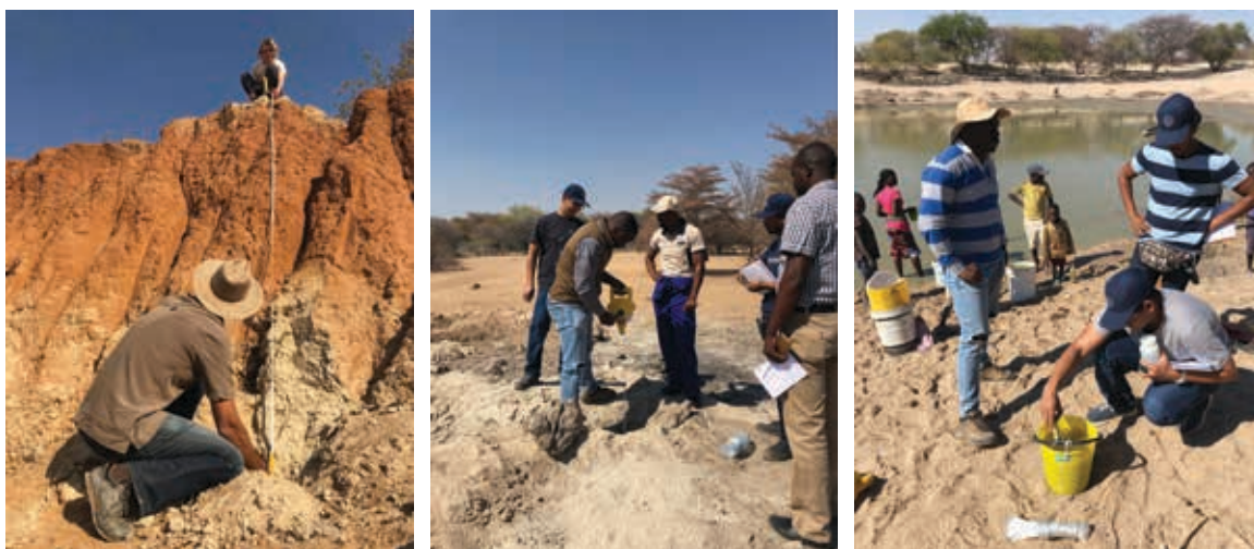
FOTOGRAFIA 4.7. Observações de geologia do solo e subterrâneas perto de Ombala Yo Mungu sede (à esquerda); Medição do nível das águas subterrâneas perto de Mongua sede (meio); e medição da qualidade da água na Comuna de Naulila (à direita)
